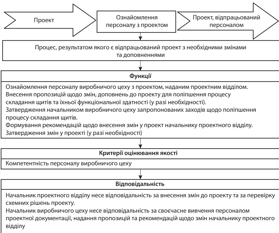
Рис. 2. Операційна процедура «ознайомлення з проектом персоналу виробничого цеху (однолінійна електрична схема)»
