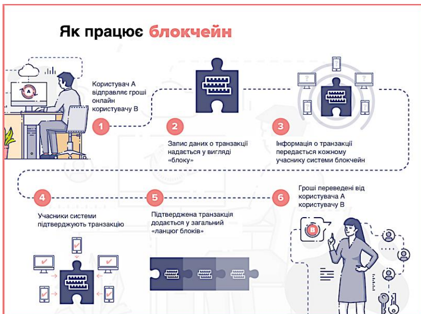
Рис. Алгоритм функціонування blockchain технології [1, с. 35]
