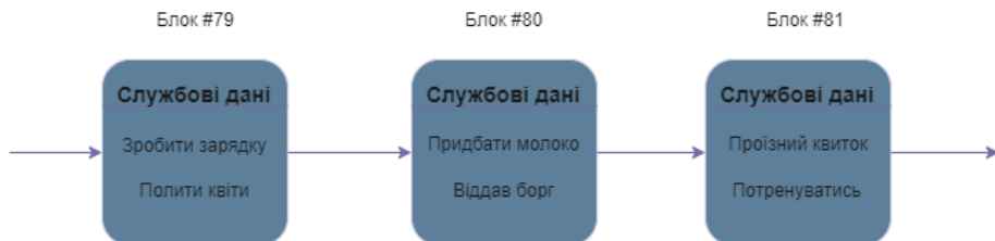
Рис. 1. Схема типового ланцюгу блоків у системі блокчейн Джерело: побудовано авторами на основі [9]
