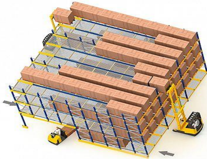
Рис. 2.14. Гравітаційна стелажна система
