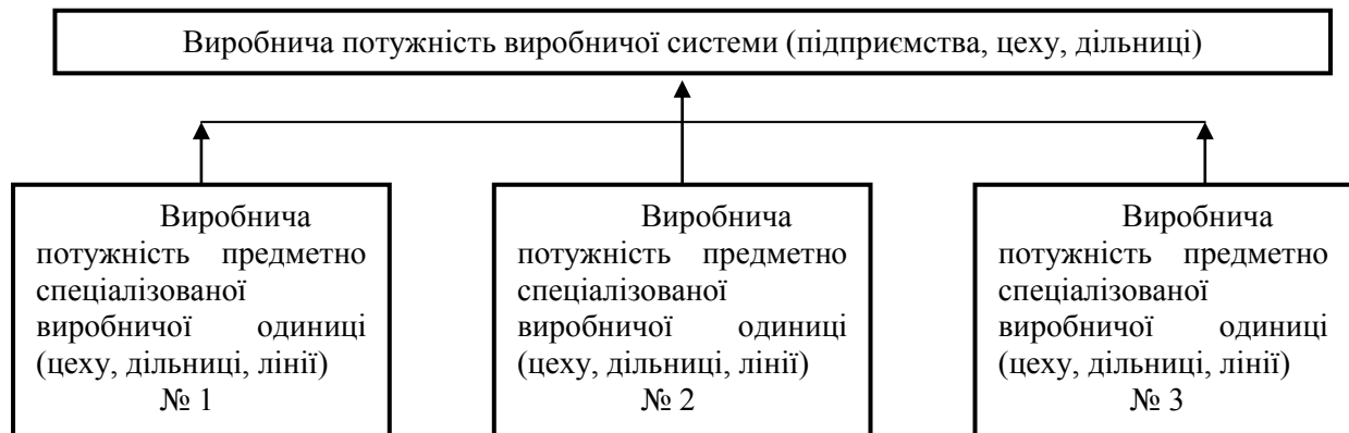
Рис. 1. Загальна схема розрахунку виробничої потужності виробничої системи при предметній побудові її структури (предметної спеціалізації її елементів)
