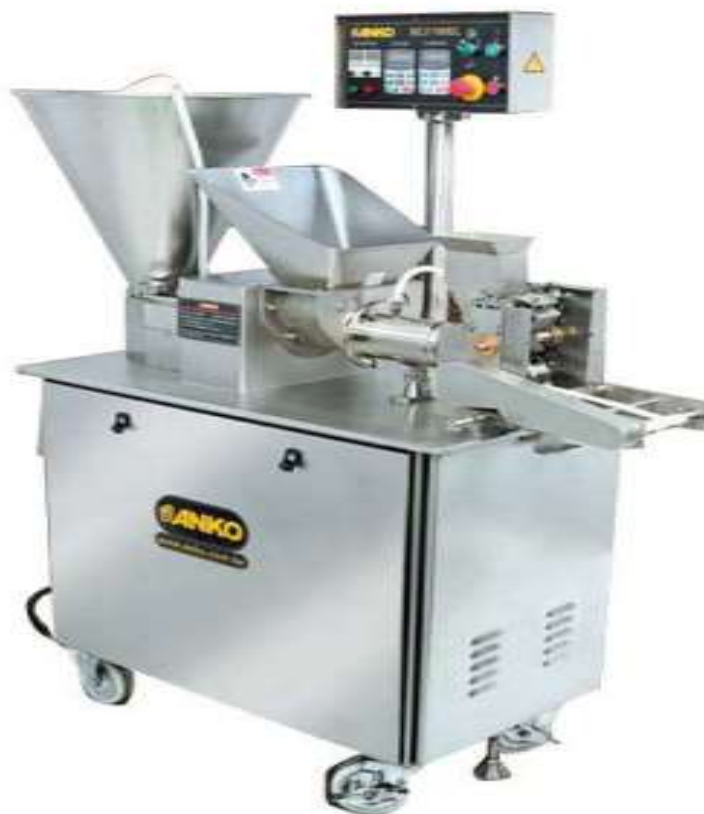
Рис. 3.2 – Автомат з виготовлення пельменно-вареничної продукції HLT-700 від фірми АНКО (Тайвань)
