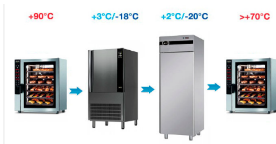
Рис. 2.13.Схема реалізації технології Cook-Chill
