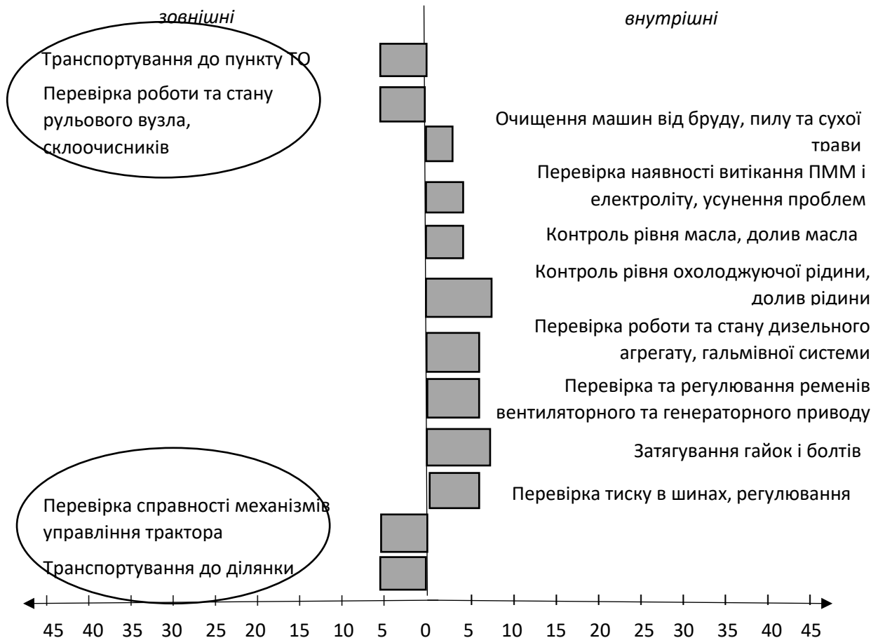
Рис. 3.7. Розподіл витрат часу на проведення основних етапів процесу щоденного огляду трактора (після змін), хвилин
