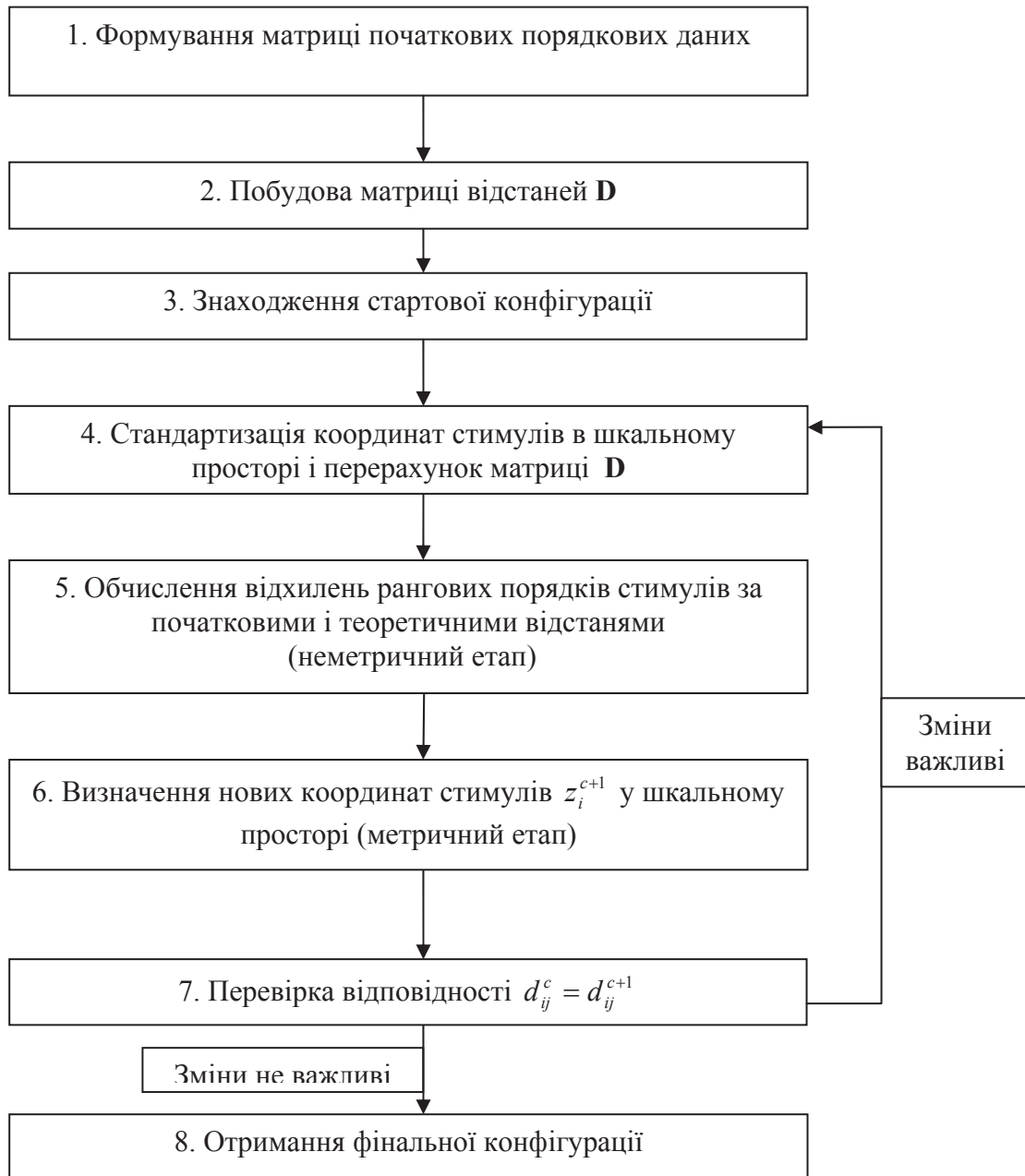
Рис. 3 – Блок-схема алгоритму неметричного шкалування
