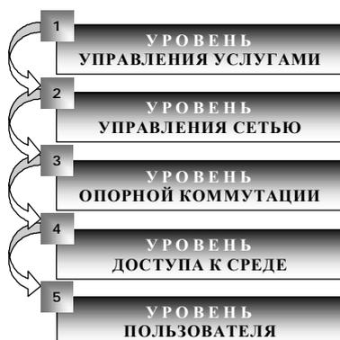
Рис. 1. Перспективная пятиуровневая модель управления МСТС
