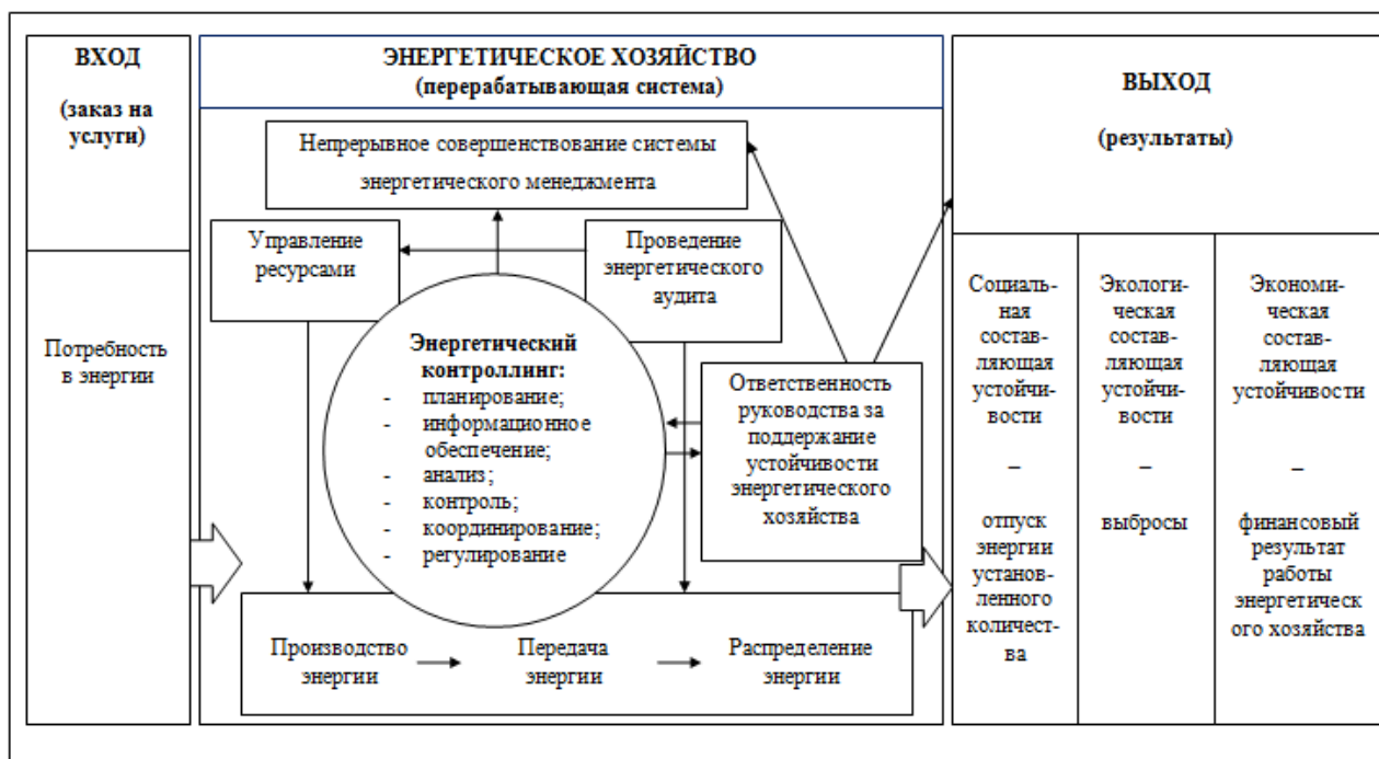
Рис. 2. Общая схема системы управления энергетическим хозяйством предприятия на основе контроллинга
