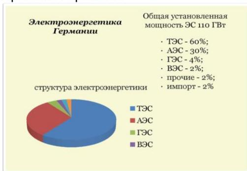
Рис. 4. Структура электроэнергетики Германии
