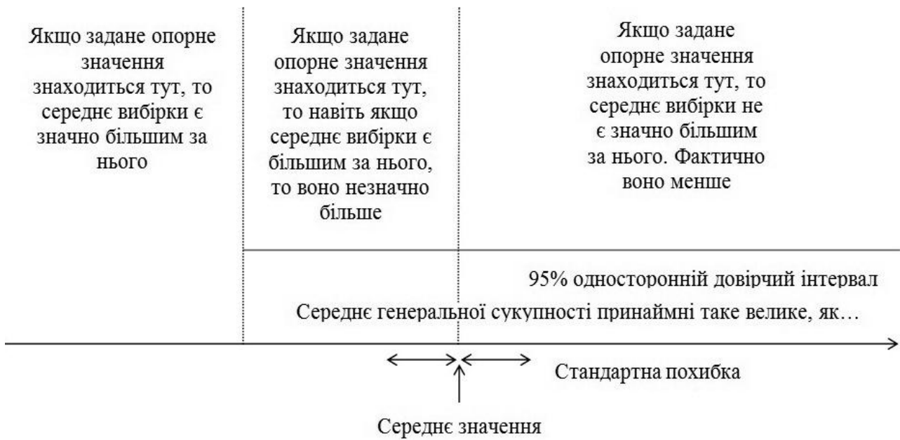
Рис. 4.4. Схема використання односторонньої перевірки для прийняття рішення про те, чи дійсно значення \mu є більшим за задане значення \mu_0 .
