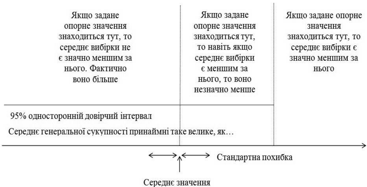
Рис. 4.5. Схема використання односторонньої перевірки для прийняття рішення про те, чи дійсно значення \mu є меншим за задане значення \mu_0 .
