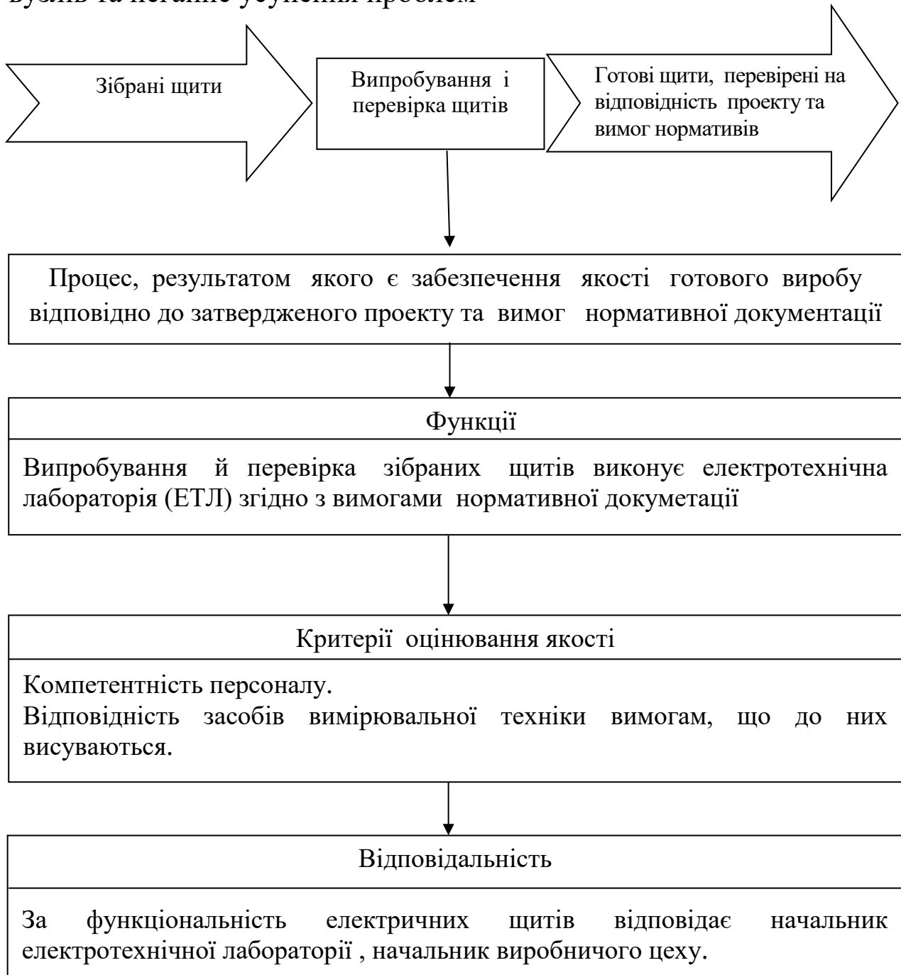
Рис. 6.14. Операційна процедура випробування і перевірки зібраних електричних щитів (Джерело: власна розробка автора)
