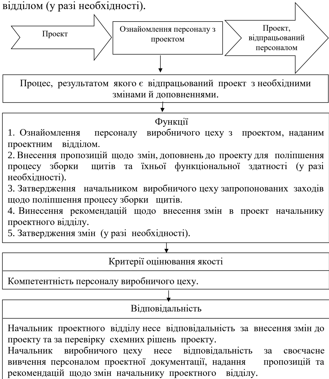
Рис. 6.10. Операційна процедура ознайомлення з проектом персоналу виробничого цеху (однолінійна електрична схема) (Джерело: власна розробка автора)
