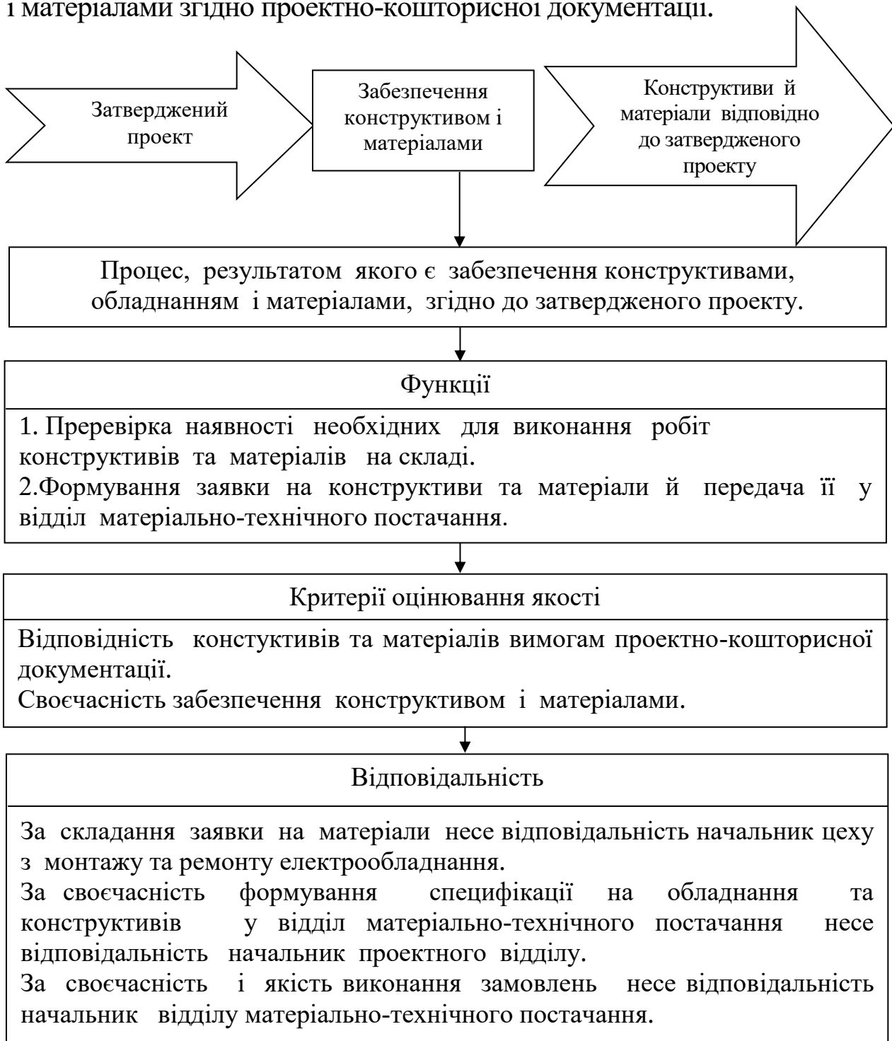
Рис. 6.4. Операційна процедура забезпечення конструктивом і матеріалами для виконання робіт з прокладання кабелів відповідно до затвердженого проекту (Джерело: власна розробка автора)
