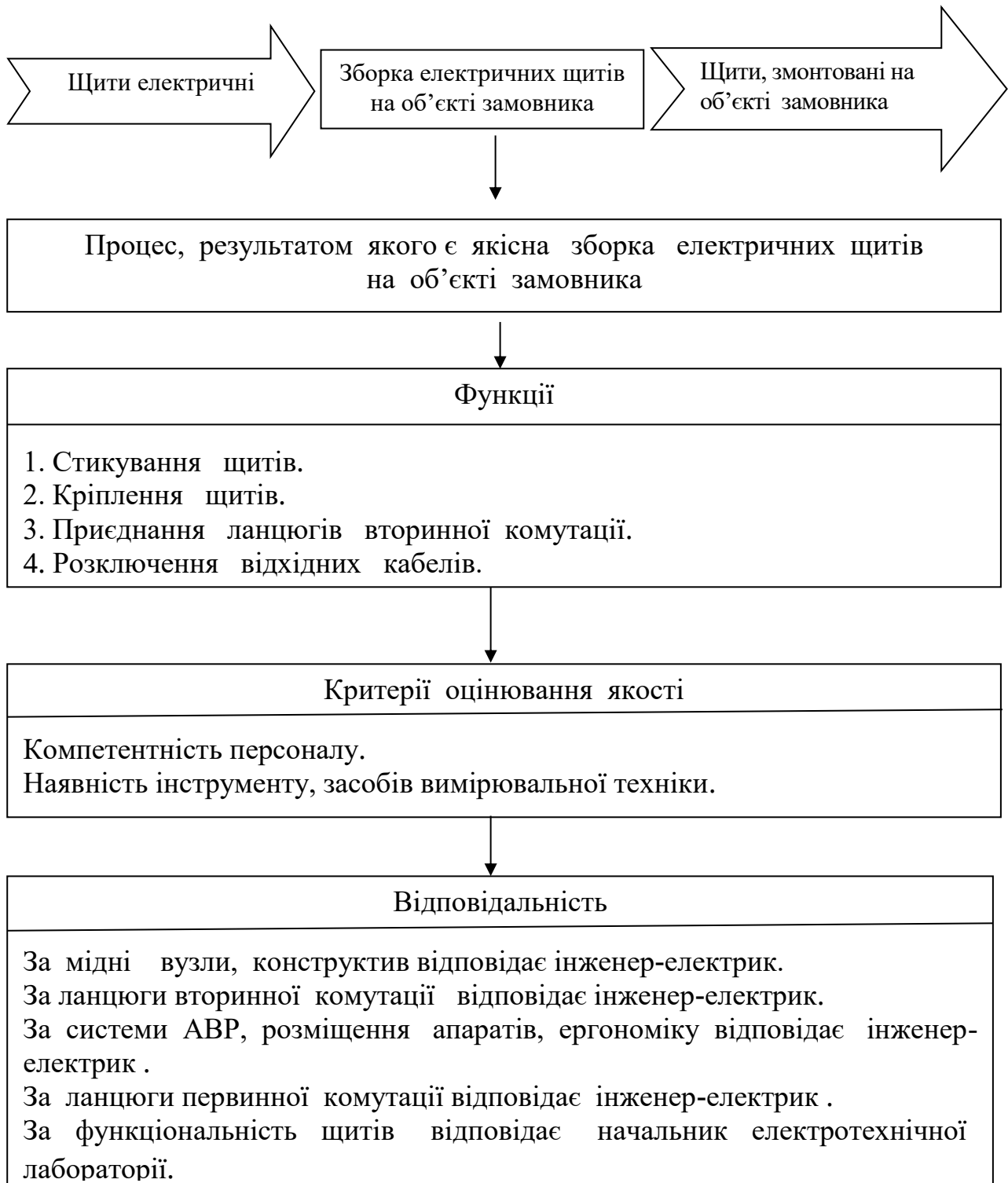
Рис. 6.16. Операційна процедура зборки електричних щитів на об'єкті замовника (Джерело: власна розробка автора)
