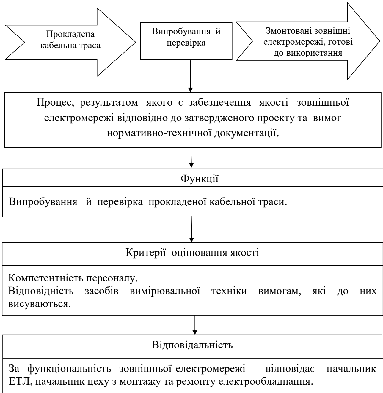
Рис. 6.6. Операційна процедура випробування й перевірки прокладеної кабельної траси (Джерело: власна розробка автора)
