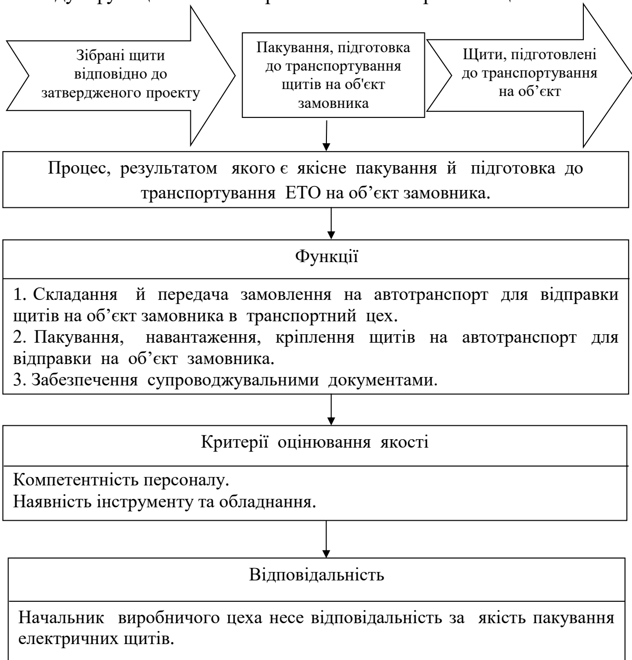
Рис. 6.15. Операційна процедура пакування, підготовки до транспортування електричних щитів на об'єкт замовника (Джерело: власна розробка автора)
