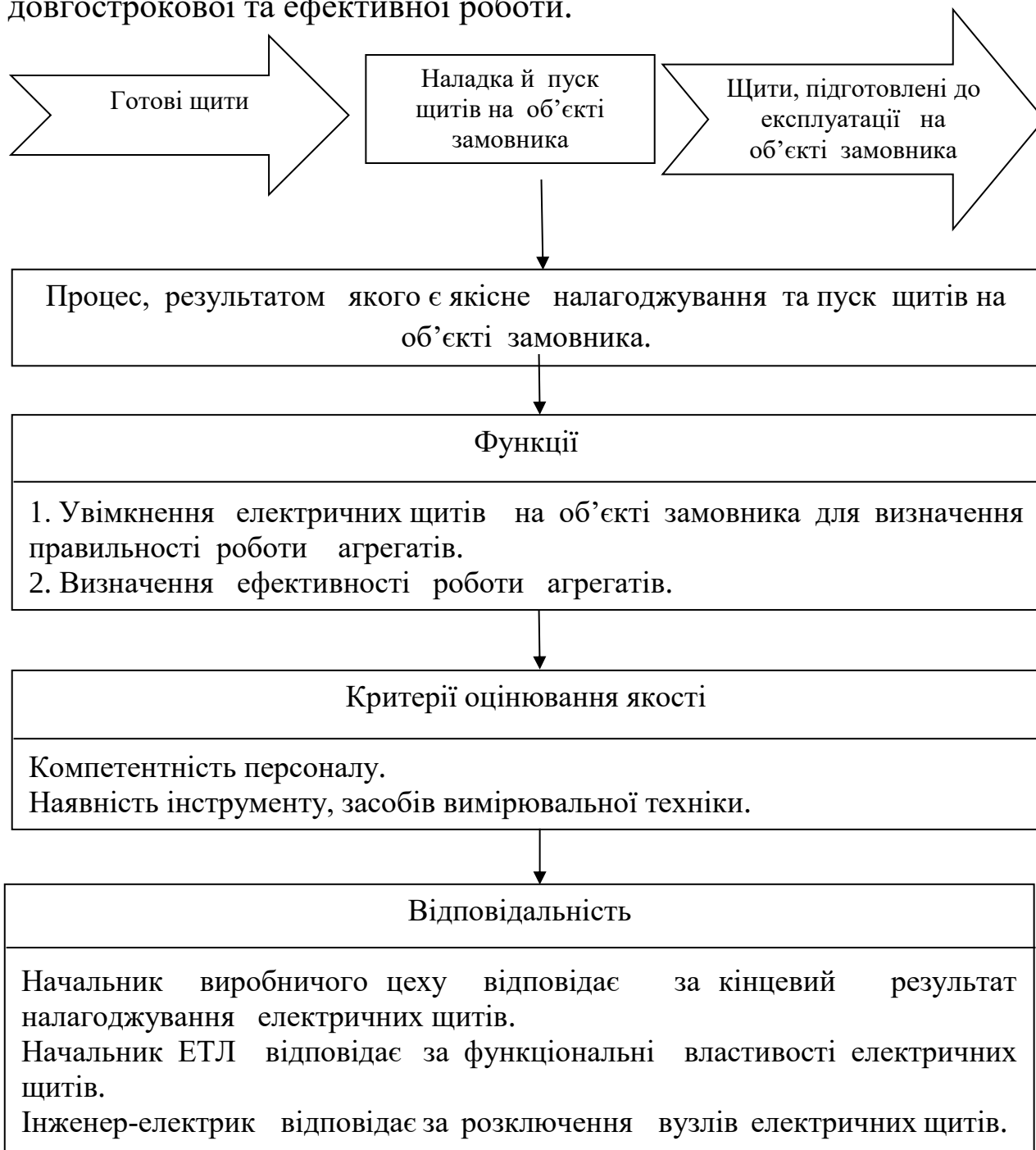
Рис. 6.17. Операційна процедура пусконалагоджувальних робіт щодо електричних щитів на об'єкті замовника (Джерело: власна розробка автора)
