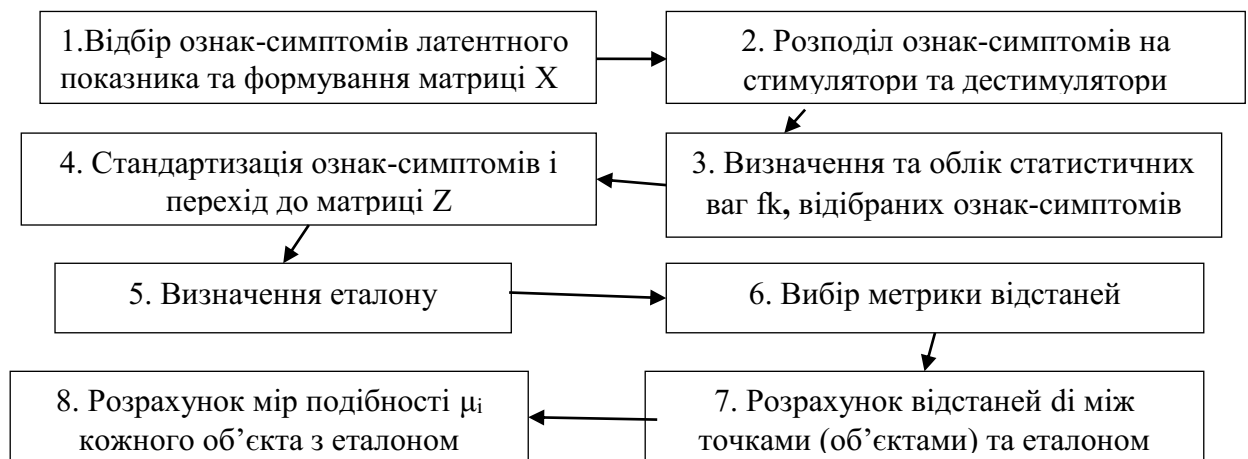
Рисунок 2.5 – Блок-схема класичного алгоритму визначення латентного показника на основі функцій відстані та подібності
