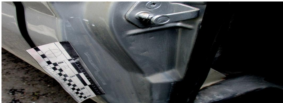
Рис.4.4.7. Місце нанесення вторинного та втретє нанесеного номера VIN із помилкою на середній стійці з правої по ходу сторони та місце нанесення номера VIN без помилок.
