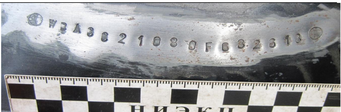
Рис.4.3. 4. Номер VIN на правій опорі амортизатора, нанесений на спеціалізованому ремонтному підприємстві
