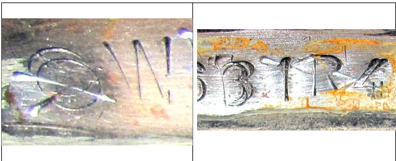
Рис.4.4.12. Збільшене зображення погашених знаків помилково нанесеного номеру VIN
