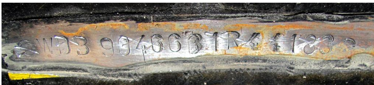
Рис.4.4.11. Вторинний номер, нанесений із помилкою, 16 знаків.
