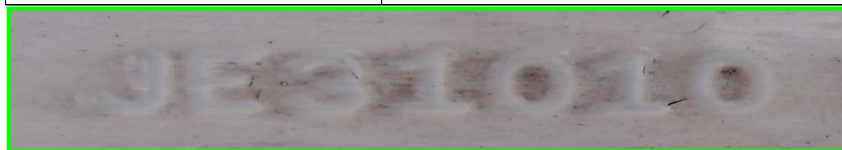
Рис.4.4.5. Детальне зображення фрагменту ідентифікаційного номера кузова на номерній табличці
