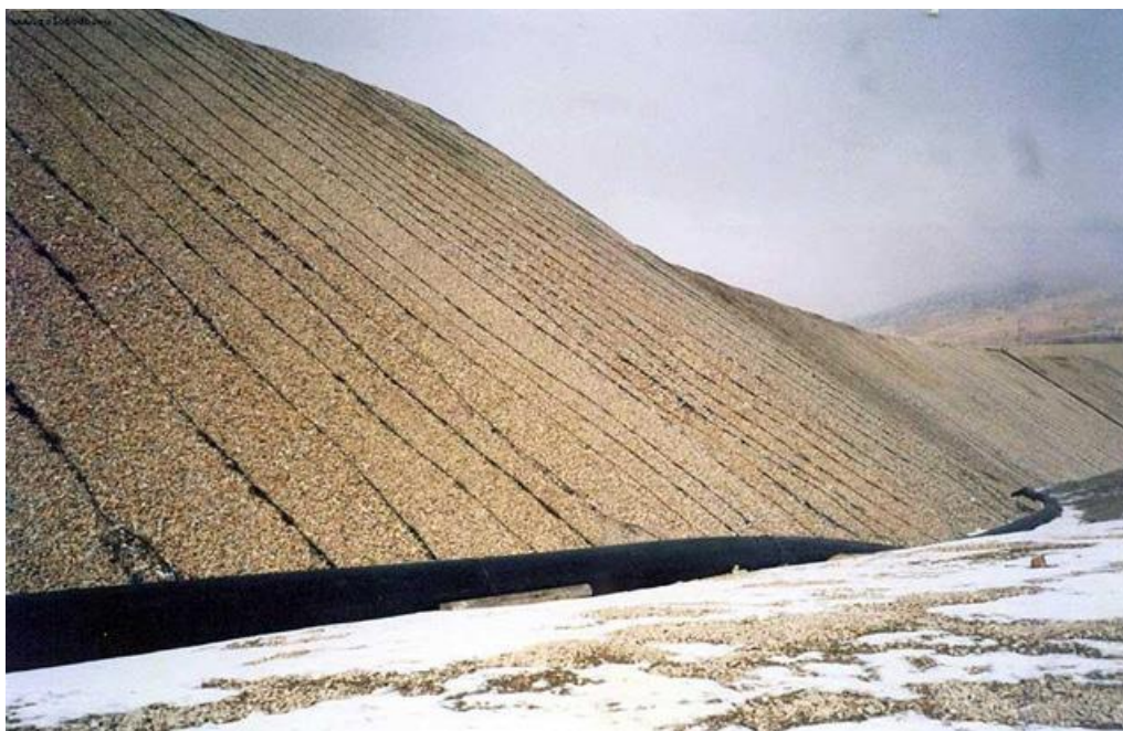
Рис. 2.3. Кучне бактеріальне вилуговування міді з некондиційних руд мідної копальні Bingham Canyon (штат Юта, США)
