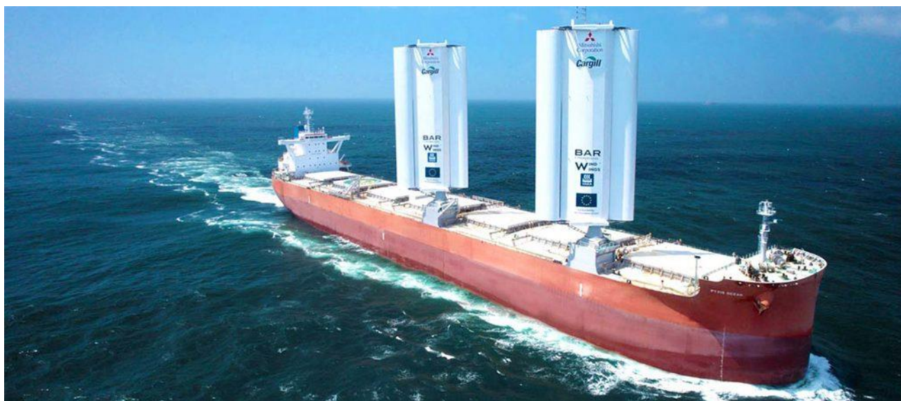
Рис. 1.6. Вантажне судно Rukh Ocean із жорсткими вітрилами
