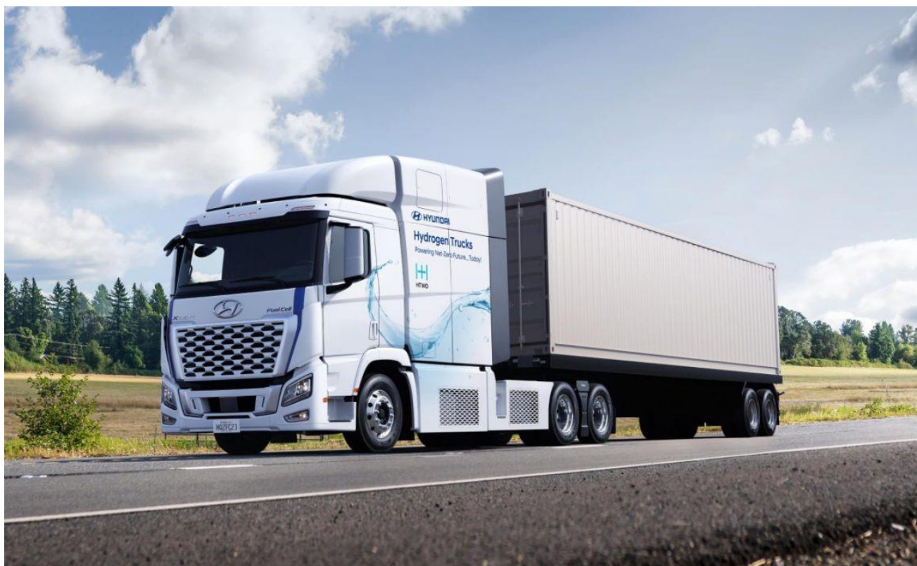
Рис.1.5. Вантажівка Xcient Fuel Cell на водневих паливних елементах Джерело: [27]
