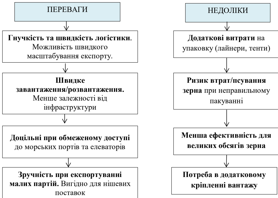
Рис. 2.11. Переваги та недоліки використання flat-rack платформ при перевезенні зерна
